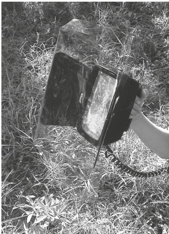
Figure 4.8 Simplement fixée devant la face d'une torche à lampe halogène (3 200 K), la « gélatine » bleue en convertit l'éclairage en « lumière du jour » (5 000 K environ).
