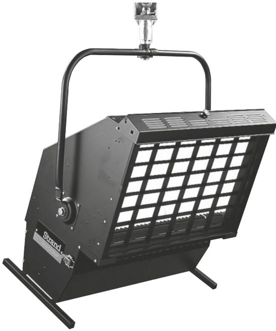
Figure 17.11 Luminaire d'ambiance TH. Le modèle représenté est équipé de deux lampes TH de 2,5 kW commutables séparément ; il atteint donc une puissance de 5 kW. « Arturo » de Strand Lighting.
