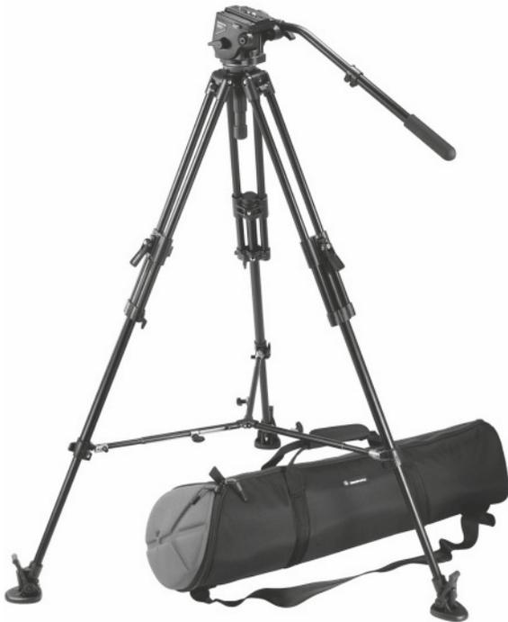
Figure 15.3 Un solide trépied, tel celui-ci muni d'une plate-forme panoramique 3D, de branches de longueur réglable consolidées par des entretoises, s'avère indispensable pour de nombreuses situations de prises de vues.
