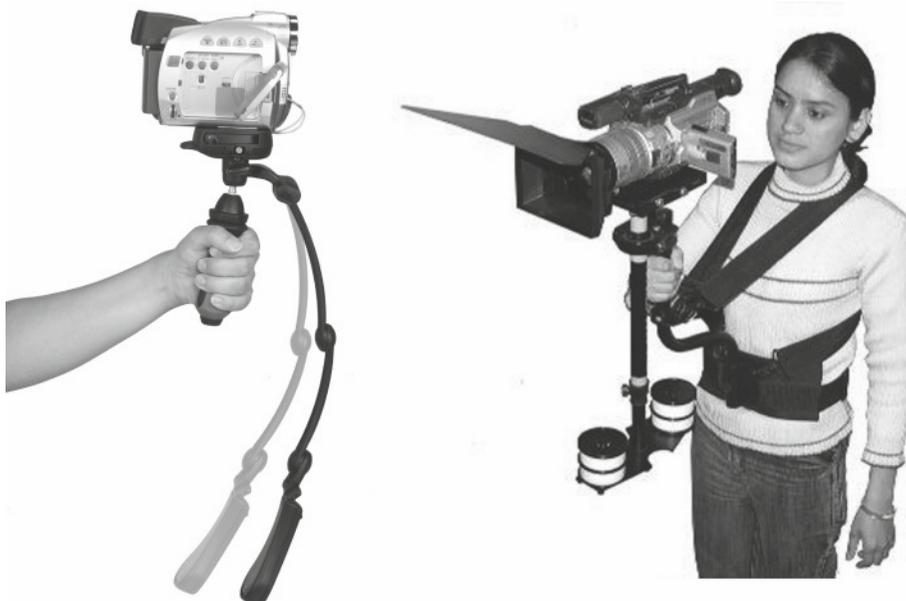
Figure 15.5 Supports stabilisateurs inertiels.
