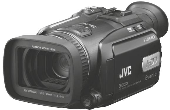
Cet élégant modèle HD tri-CCD (1/5", 570 kP) est pourvu d'un zoom 10× (3,3-33 mm/f/1,8, équivalent à un 39,5-395 mm en 24 × 36). Il enregistre en Full HD en MPEG-2 TS 1080i sur disque dur 60 Go, lequel lui confère une confortable autonomie de 7 heures de tournage. La connectique est très complète : sortie HDMI, sortie DV, sortie USB-2, sortie vidéo composantes, sortie S-Vidéo, sortie audio/vidéo analogique et prise pour microphone externe stéréo. Dimensions : 88 × 78 × 184 mm. Poids : 747 g.
