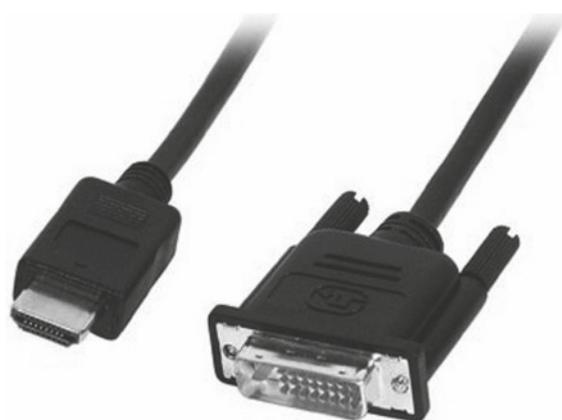
Figure 32.10 Connecteur HDMI (à gauche). Tous les équipements vidéo haute définition grand public en sont désormais pourvus. Cette interface facilite considérablement les liaisons entre les appareils source (lecteur DVD/BD, caméscope HD, appareil photo numérique) et les écrans destination (téléviseur et moniteur). Connecteur DVI (à droite) : il est plutôt réservé aux applications de monitoring numérique informatique.
