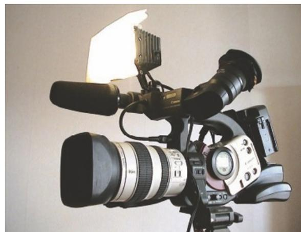
Figure 17.16 Éclairage d'appoint monté sur la caméra. Ce caméscope Canon Série XL est ici bien équipé pour le reportage « volant » : microphone éloigné du corps de l'appareil et torche d'appoint délivrant une puissante lumière diffuse.
