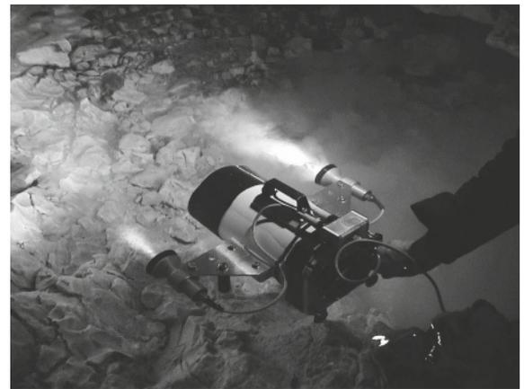
Figure 15.11 Camescope en caisson étanche utilisé ici en spéléologie.
