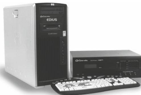
Figure 19.1 Un ordinateur de bureau classique convient pour le montage des formats vidéo de définition standard 4:3 (SD).
