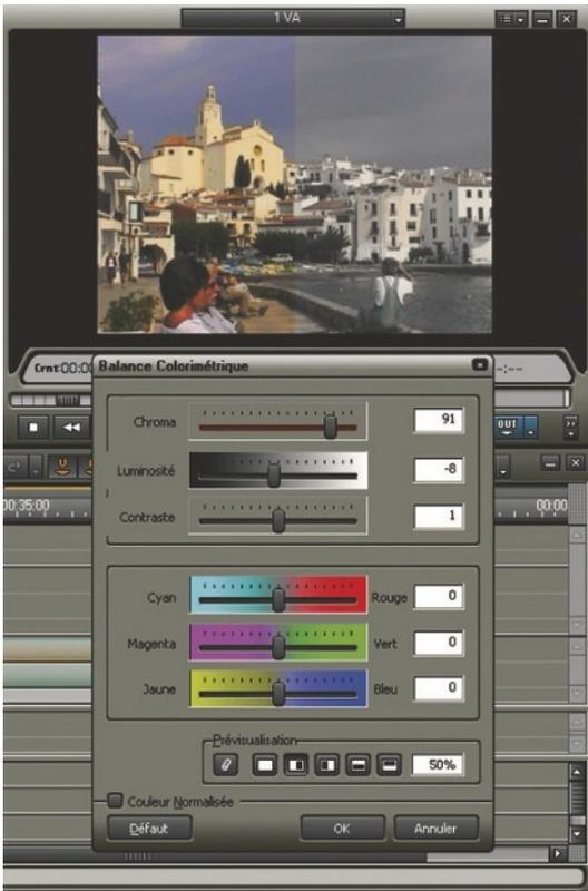
Figure 21.14 Panneau de corrections colorimétriques simples par la manœuvre de curseurs, dans le logiciel de montage Grass Valley Edius. *Image Gérard Galès.*
